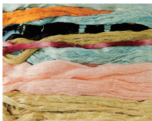
糸を台に叩きつけて染料を染みこませ、美しい色合いに染め上げる。
