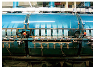
繰糸した糸を巻き返し、絹本来の安定した状態に戻す「揚返し」の工程。
