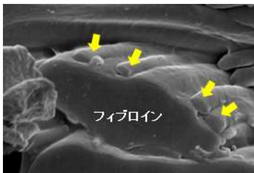
図1. 繭糸分離細繊維(矢印)が発生した繭糸断面
