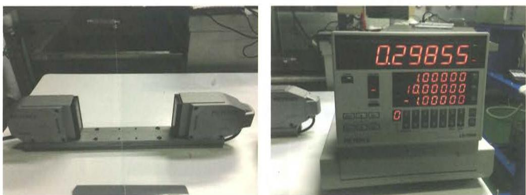
図4. 高速・高精度デジタル寸法測定器 (KEYENCE 製 LS-7030)
