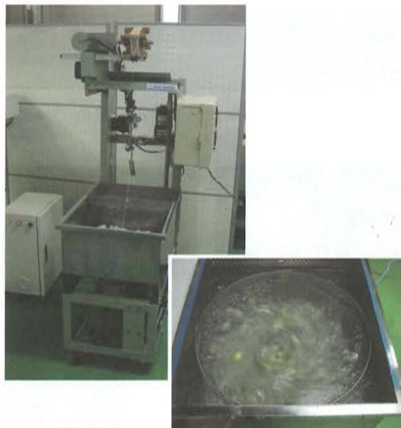
図1. 繭糸交絡攪拌繰糸機
