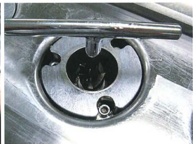
図 12. シャフトの固定 (左) によるカップリング B の着脱 (右) の様子
