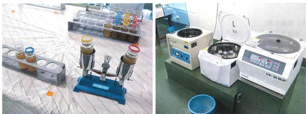
図24. 濾液のバランス調整（左）と遠沈処理の様子（右）
