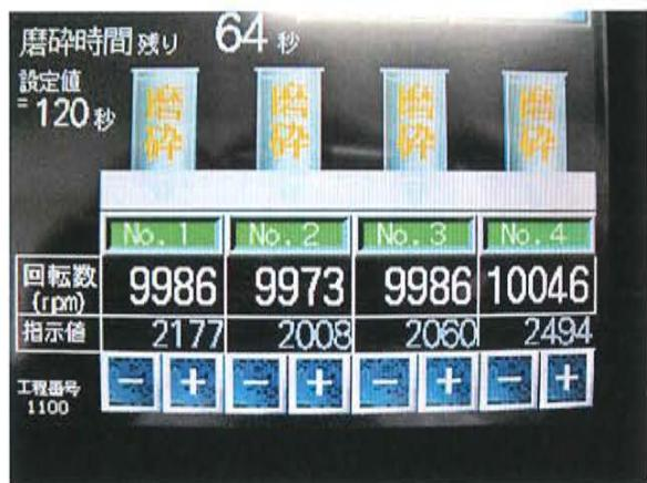
図 9. タッチパネルに表示された磨碎工程の様子
