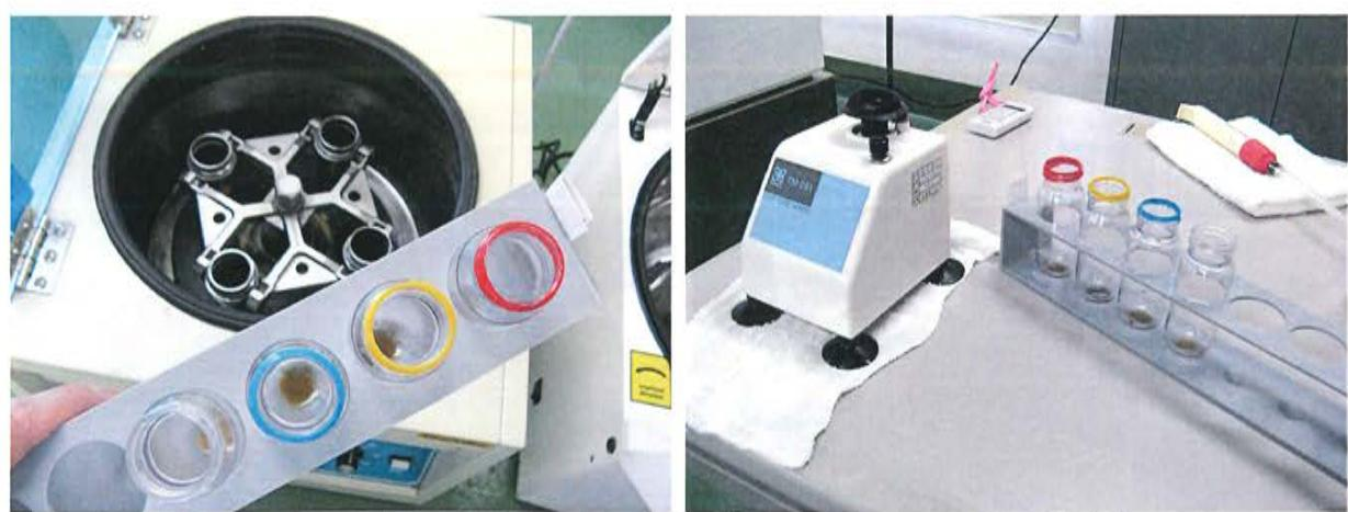
図25. 回収された沈殿物（左）と試験管ミキサーによる攪拌処理（右）
