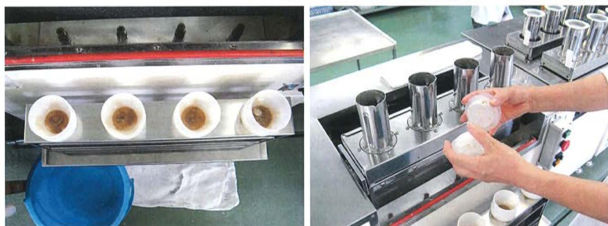
図 22. 濾液の回収後（左），カップのフタを外して洗浄工程に入る様子（右）
