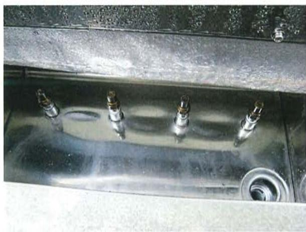
図 15. 高圧ノズル（左）による磨碎カップの洗浄（右）
