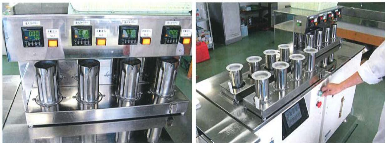
図 21. 磨碎液の注入（左）と磨碎処理の様子（右）
