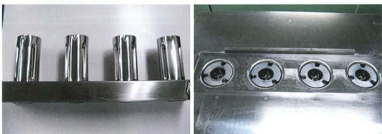
図 8. フォルダーに装着された磨碎カップ（左）と磨碎装置上の設置部位（右）
