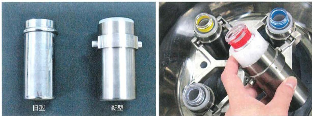
図 26. アダプターを装着した金属バスケットによる遠沈処理
