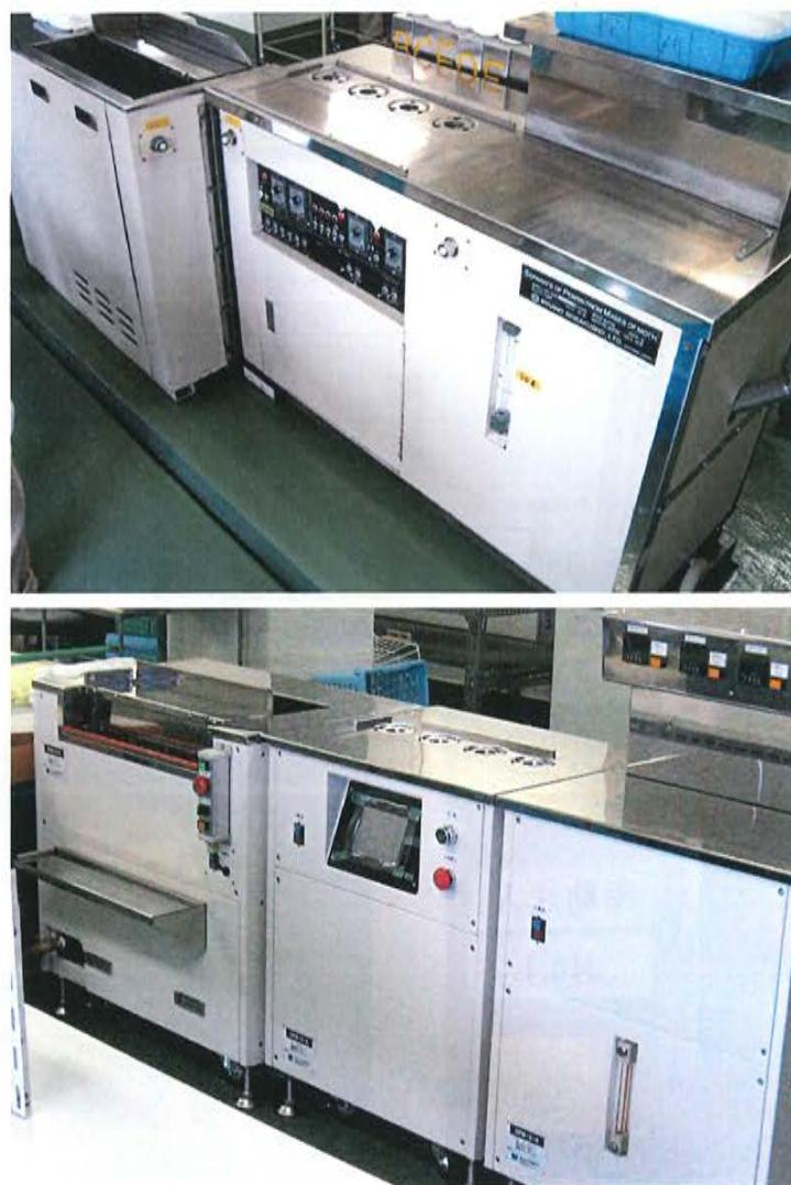
図 3. 集団母蛾磨碎装置 SPM 2（旧機種：上）および SPM 2-4（新機種：下）
