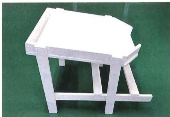
図2 作製した蚕種洗い落とし台
