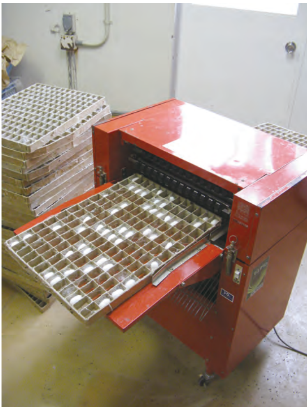
写真4：収繭毛羽取機も核多角体病ウイルスに汚染され易い
