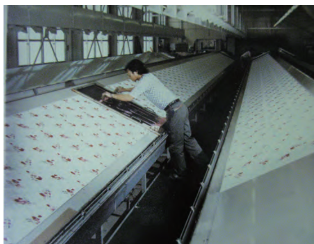
(写真 31) スカーフのスクリーン捺染 (シルク博物館所蔵)
