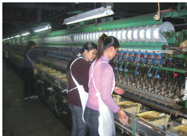
今や中国で稼働する繰糸機の9割は 中国製自動繰糸機
