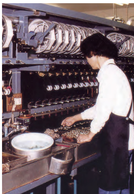
図7 生繭から多条繰糸機でゆっくり繰糸（野村シルク博物館パンフレットより）
