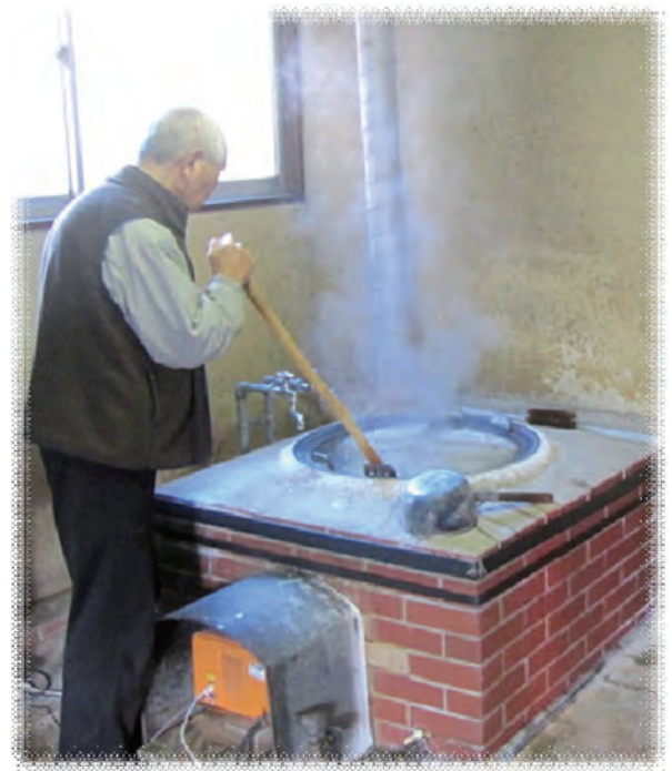
図4 糸の中性還元精練の実施状況（加藤機業場、高橋弘直氏提供）
