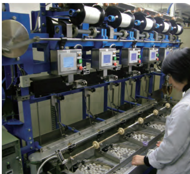
図1 万能繰糸機による繰糸状況
