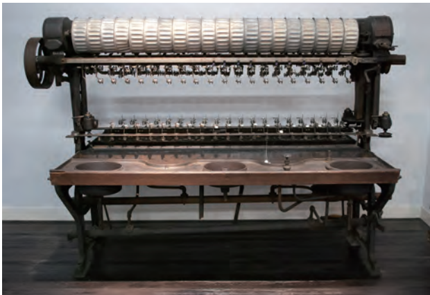
写真2 御法川式繰糸機
