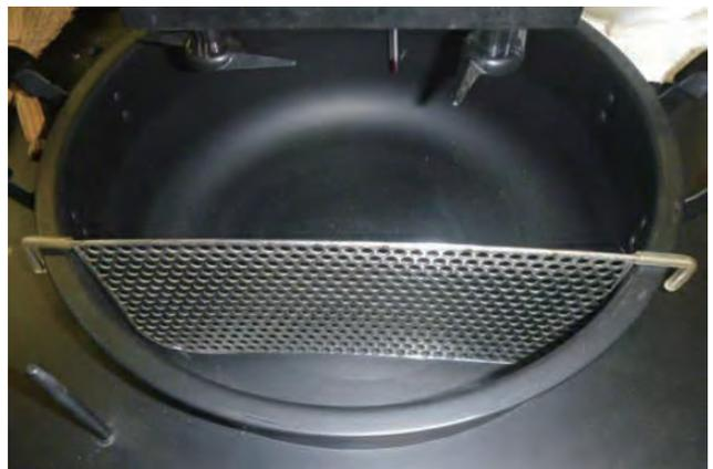
図3 黒く焼付塗装したステンレス製IH鍋と仕切板
