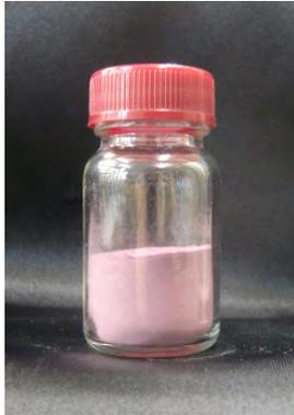
シルクフィブロインの透析後の溶液に金ヒドロゾルを混合すると、写真4のような淡赤紫色のパウダーが得られます。これは、金の超微粒子による発色であるため、変色や退色がありません。
