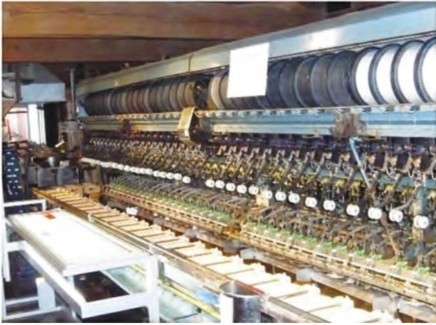
写真4 日産製K8型自動繰糸機
