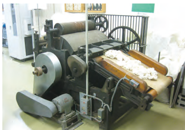
写真5：絹糸紡績工程の開綿機 (写真提供：信州大学繊維図書館)
