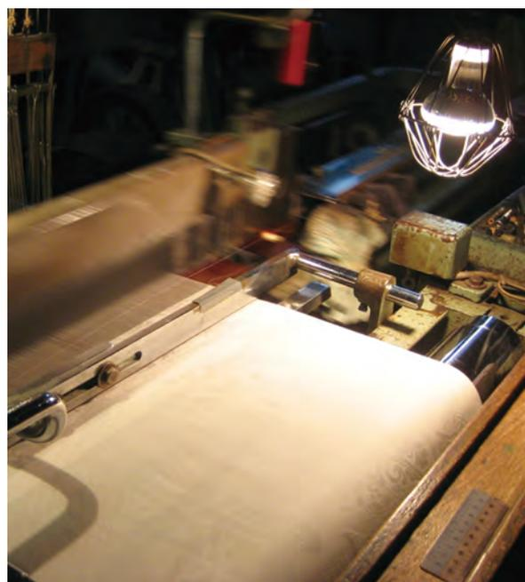
図 6：動力織機による機械織
