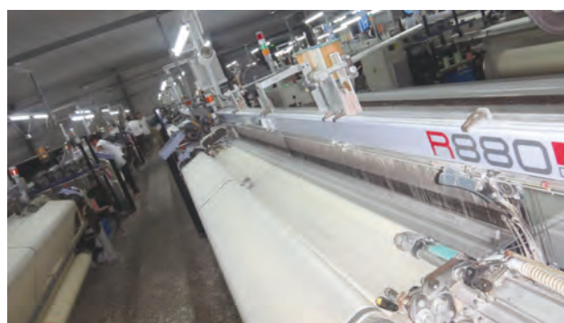
写真7：新設されたレピア織機
