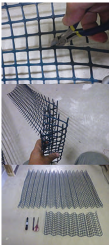
図5 トリカルネットでの族作成 ニッパで切る(上)、折り目をつける(中央)、完成(下)
