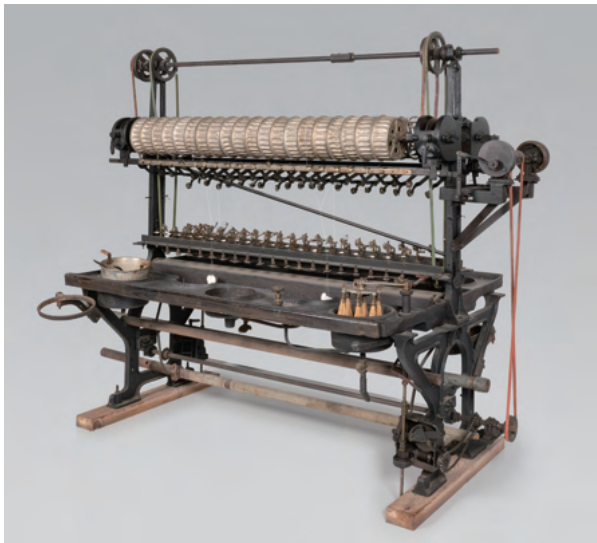
御法川式多条繰糸機 (写真提供：岡谷蚕糸博物館)
