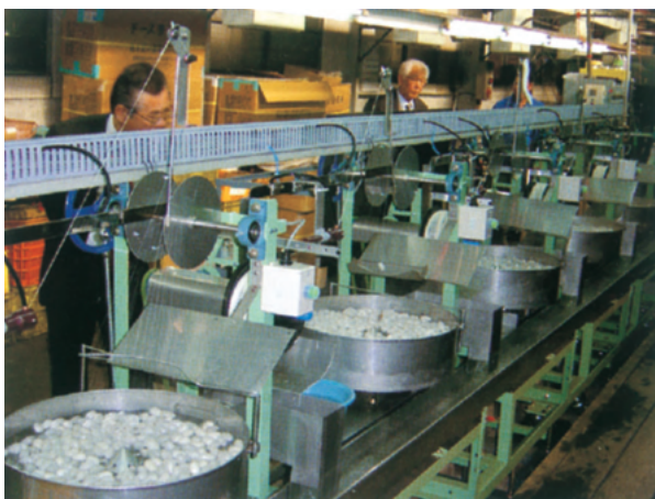
工場における5緒型繰糸機の稼働状況
