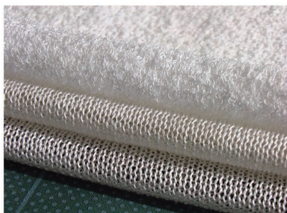
図7 編地表面の違い（上：新シルクデニット糸、中：絹紡糸、下：練糸）
