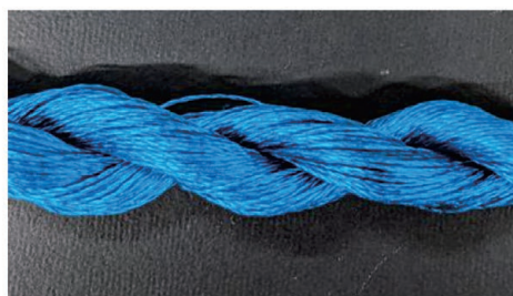
(b)染料濃度 10%OWF-未処理系(精練のみ)(繊維重量の 10%の染料を使用)
