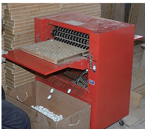
自動収繭毛羽取機「マユクリン」
