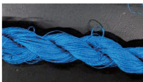
(a)染料濃度 3%OWF-SS 処理系 (繊維重量の 3%の染料を使用)
